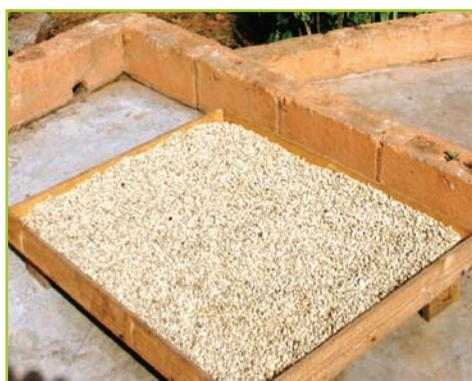
Figura 10. Secado en caja de madera
