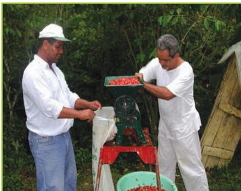
Figura 5. Despulpado de muestras de café cereza
